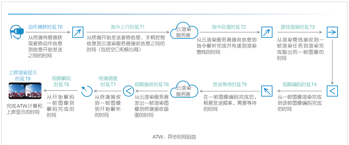
▲图3 中兴通讯XR云平台端到端时延分解
