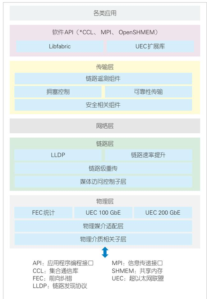
▲图2 超以太网协议栈整体架构示意
