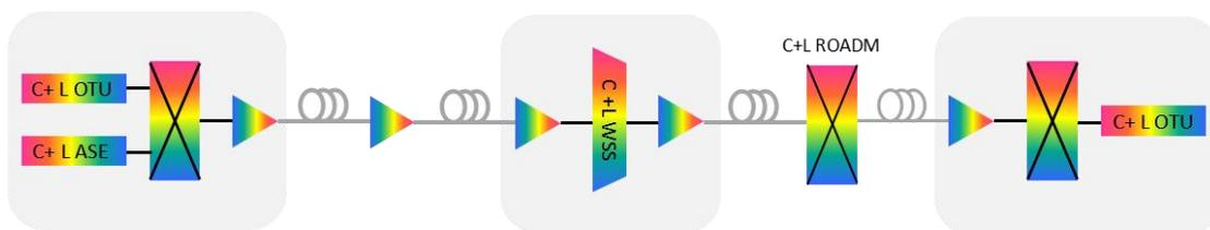
图 1.6 C+L 四阶段系统组网示意图
